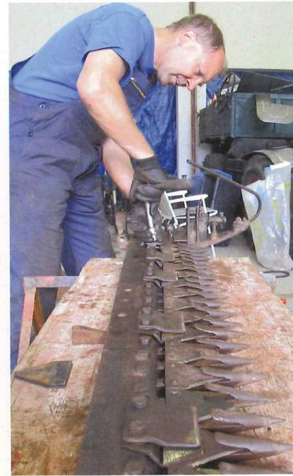
... bestimmte Finger läuft – das hat einwandfrei zu funktionieren. Noch einmal der Aufbau der Messerführung: oben der Halter (der sozusagen ...
