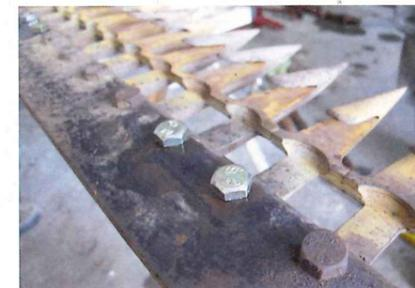
... unter Umständen den Messerlauf, da sich der Druck auf einzelne Klingen erhöht bzw. deren Reibung beim Schneiden zunimmt
