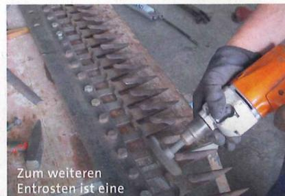
Zum weiteren Entrosten ist eine Bohrmaschine mit Drahtbürstenaufsatz auch nicht zu verachten
