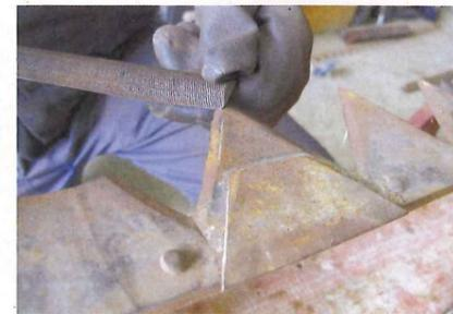
... etwas nachgeschliffen werden. Dazu zieht man die Feile schön gleichmäßig im richtigen Winkel an den Schneiden entlang. Je nach ...
