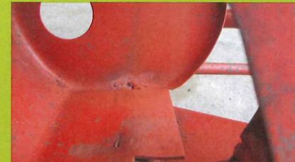
... ist somit zu 100 Prozent wiederhergestellt. Wer mehr will, muss die Schweißnähte sauber verschleifen, ohne die neuen Verbindungen ...
