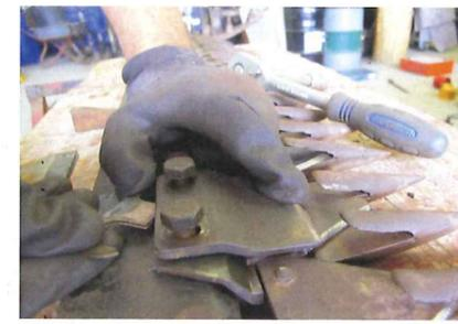
Und je nach Verschleißgrad von Fingerplatten, Klingen und Reinigungsplatten kann die ganze Konstruktion durch Weglassen einer Lamelle ...
