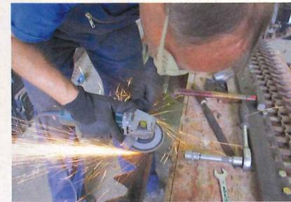
... werden will. Die Vorgehensweise wiederholt sich: Nietkopf auf der Oberseite des Messers abschleifen, anschließend wird der Niet ...
