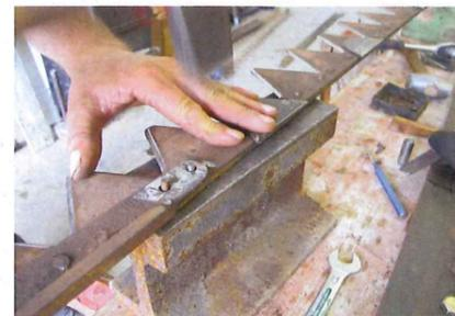
Zurück zum Messer: Die beiden Nieten am Ende des Messerkopfs werden „erneuert“. Man steckt sie von unten durch Messerrücken, Klinge ...
