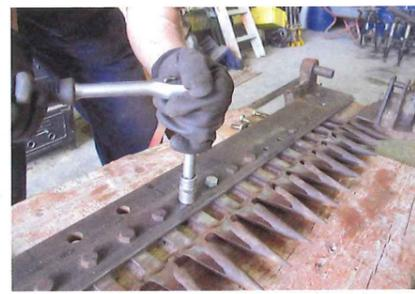
Messer fertig, Balken fertig: Zeit, wieder alles zu montieren: Die provisorisch eingedrehten Schrauben kommen raus, da ja die Halter ...
