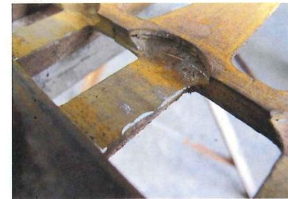
Schleifspuren am hinteren Teil der Finger deuten daraufhin, dass das Messer nicht sauber im Balken läuft. Bestenfalls hat ein Fremdkörper ...
