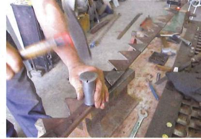
Anschließend kommt für das Stauchen des Niets der Kopfmacher zum Einsatz. Er sollte von der Bohrung her zum Nietdurchmesser und ...
