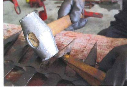
... angesagt: Mit einem kleinen Keil aus Holz oder Kunststoff als Unterlage klopft Thomas – soweit möglich – zunächst die Lippen der ...
