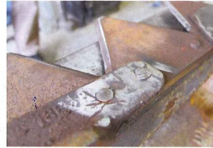
... Unterlage rutscht. Auf der Unterseite ist noch zu beachten, dass der angesetzte Anfang der Bohrung nicht zu groß sein darf für den Niet
