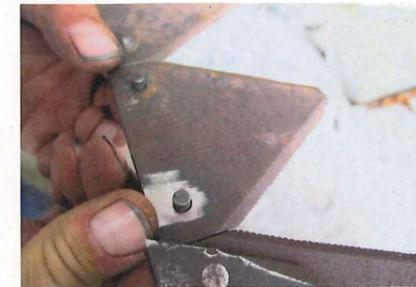
... oder zwei ausgetauscht werden. Laut Eicher-Ersatzteilliste haben die Flachköpfe die Maße 5,3 x 16 Millimeter (Durchmesser x Länge)
