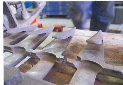
Ist der größte Rost beseitigt, „schimmern“ die Nieten durch, mit denen die Fingerplatten befestigt sind. Wer seinen Mähbalken auf ...
