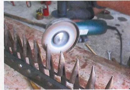
... abgelenkten Spitzen oder Überständen kann man entweder mit verschiedenen Feilen oder einem Einhand-Winkelschleifer zu Leibe rücken
