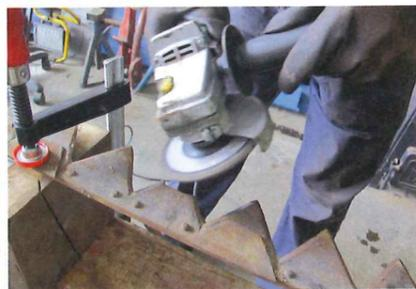
Mit einem Winkelschleifer funktioniert das Anschleifen der Klingen natürlich wesentlich schneller, aber dabei ist Fingerspitzengefühl ...
