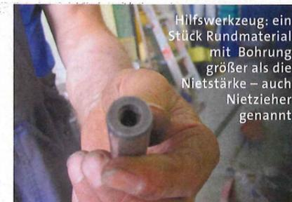
Hilfswerkzeug: ein Stück Rundmaterial mit Bohrung größer als die Nietstärke – auch Nietzieher genannt
