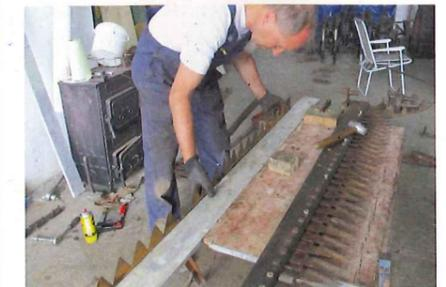
... Anlegen der Aluschiene kontrollieren. Die Stahlschiene, welche die Klingen trägt, ist nun augenscheinlich gerade – das reicht
