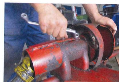
... in Ordnung. Das Gelenk wird zusätzlich durch einen Blechzylinder mit Befestigungslasche geschützt. Zwei Schrauben halten das Ganze:
