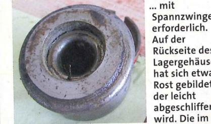
... mit Spannzwinde erforderlich. Auf der Rückseite des Lagergehäuses hat sich etwas Rost gebildet, der leicht abgeschliffen wird. Die im ...
