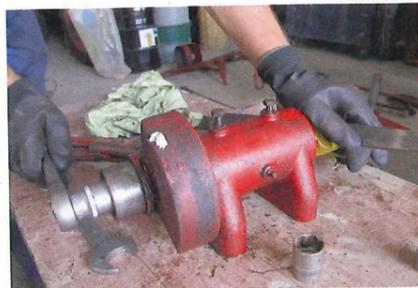
... einem gekröpften Ringschlüssel. Am anderen Ende, am Kreuzgelenk, hält man gegen. Einfach irgendetwas als Hebel durch das Gelenk stecken
