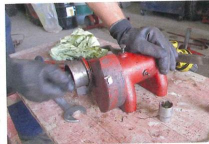
Das Abschrauben der Mutter läutet den letzten Akt in Sachen Demontearbeiten am Gehäuse ein. Es folgt die Beilag- oder Sicherungsscheibe
