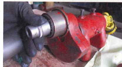
Wichtig: Bei der Montage muss das Lager mit der ausgefrästen Seite in der Außenschale voran in das Gehäuse geschoben werden (Bild oben)
