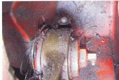
... zu fühlen: Dazu will die Spannschraube der Kurbelwellenbrille gelöst werden (oben im Bild) – ein etwas kniffliges Unterfangen, da die ...
