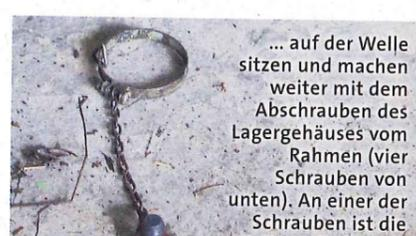
... auf der Welle sitzen und machen weiter mit dem Abschrauben des Lagergehäuses vom Rahmen (vier Schrauben von unten). An einer der Schrauben ist die Kette befestigt, an der die Schelle hängt
