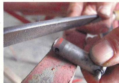
... Spuren von Hammerschlägen auf. Thomas nimmt daher eine Feile zur Hand, um sie etwas zu „entgraten“. Beim eigentlichen Winkelhebel ...
