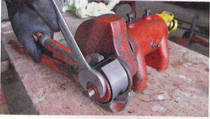
... Letzt den Abtrieb. Um vorn den Lagerdeckel losdrehen zu können, muss Thomas mit einer Rohrzange gegenhalten. Damit das Material ...
