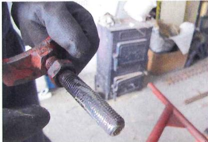
... Mähbalkens, sie sichert den Rahmen lediglich vorm Herauspringen aus seinen Halterungen unterm Traktor. Das Gewinde wird gesäubert ...
