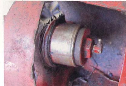
Der Kurbeltrieb sieht bis auf etwas „Flugrost“ noch völlig intakt aus. Verkrusteter Schmutz sowie „verfettetes“ Gras werden entfernt
