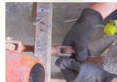
Dabei muss so mancher Splint zerstört werden, um ihn zu entfernen. Das ist aber nicht schlimm, da diese Teile sowieso erneuert werden sollten
