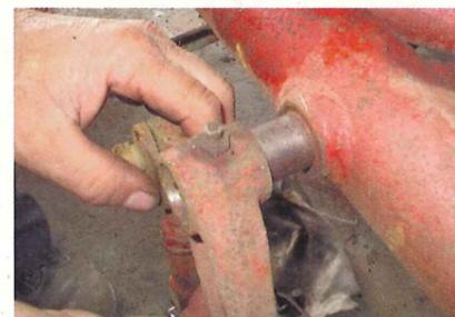
... Abziehen des Hebels von der Aufnahme am Tragrahmen des Mähwerks. Ist dieser Bolzen „trocken“, so hat er im Laufe der Zeit etwas ...
