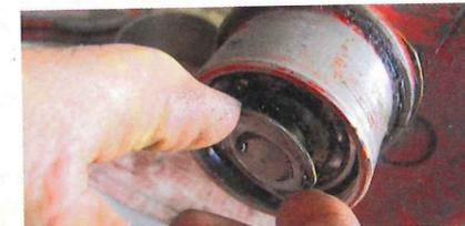
Beim Herausnehmen wird deutlich, wie und wo die Sicherungslasche in das Gewinde des Kurbelendes greift. Das Innenleben des ...
