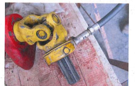
... drückt so lange frisches Fett in die Bauteile, bis es sichtbar hervorquillt – und somit die alte Schmiere überall weitgehend verdrängt hat
