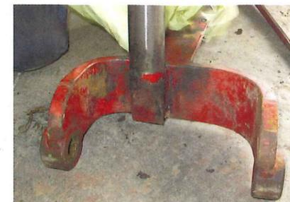
... und etwas entrostet werden. Wer den Lack nicht weiter beschädigen möchte, arbeitet hier mit einem Spachtel oder Keil aus Kunststoff ...
