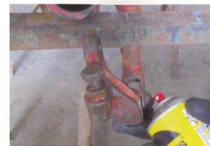
... außen am Aufnahmerohr des Bügelbolzens weiter. Der Nippel ist durchgängig. Als nächstes kommt die Aufzugsverbindung an die Reihe ...
