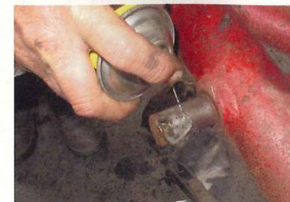
... Oberflächenrost angesetzt. Einlaufspuren sollten die Ausnahme sein, den Rost entfernt man, etwaigen Graten rückt man erneut mit ...
