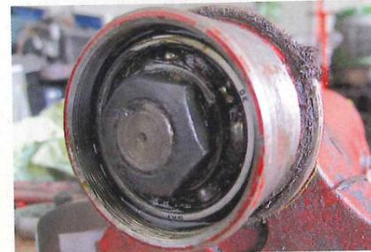
Ist die Sicherung mit einem Meißel oder einem Durchschlag runtergeklopft, wird die Mutter gelöst – vorzugsweise mit einer Nuss oder ...
