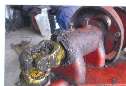
Entfernen und danach die Schrauben wieder eindrehen. Das Kreuzgelenk wird zumindest grob gereinigt und begutachtet. Dreht es ...
