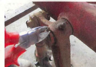
... wiederholt sich das Prozedere: Auch hier ist das Abkneifen der Splintenden leichter als das Hochbiegen, um die „Sicherung“ zu entfernen
