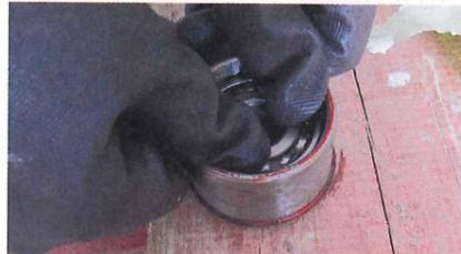
Das Kugellager lässt sich zwar per Hand in das Gehäuse drücken, es schiebt sich aber beim Aufsetzen auf das Kurbelende wieder heraus
