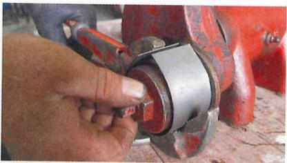
... dabei nicht beschädigt wird, behilft er sich mit einem Blechstreifen als Schutzmantel um die entsprechende Oberfläche. Nachdem der ...
