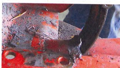
Das Material ist nicht nur auf der Unterseite eingerissen, sondern auch noch am Rohr des Tragrahmens gebrochen beziehungsweise ...
