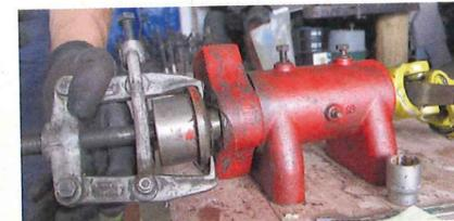
Für viele ein Spezialwerkzeug: Ein zweiarmer Abzieher mit seitlicher Spannzwinde leistet gute Dienste beim Entfernen des kompletten ...
