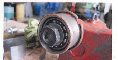
Der Deckel hat eine ähnliche Ausfräsung für überschüssiges Fett. Die „Montage-Nuss“ (links) muss auf die Innenschale des Lagers passen
